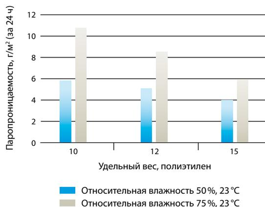
Этот график отражает объем водяных паров, проникающих в материал за 24 часа в зависимости от удельного веса полиэтилена в упаковке при различных значениях относительной влажности.
